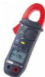
Figura 4 – Pinça Amperimétrica (multimétrica) utilizada na medição
