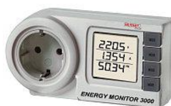
Figura 5 – Instrumento utilizado na medição e registo do consumo de energia elétrica de equipamentos
